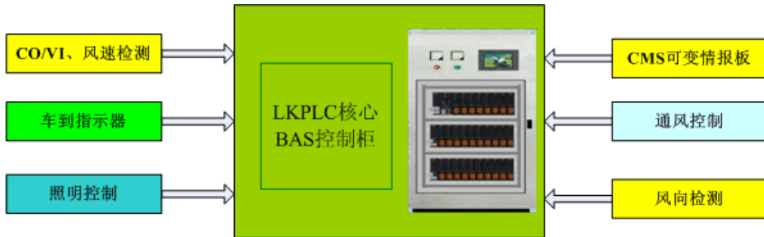
2.2 隧道监控系统的 PLC 控制柜示意图
