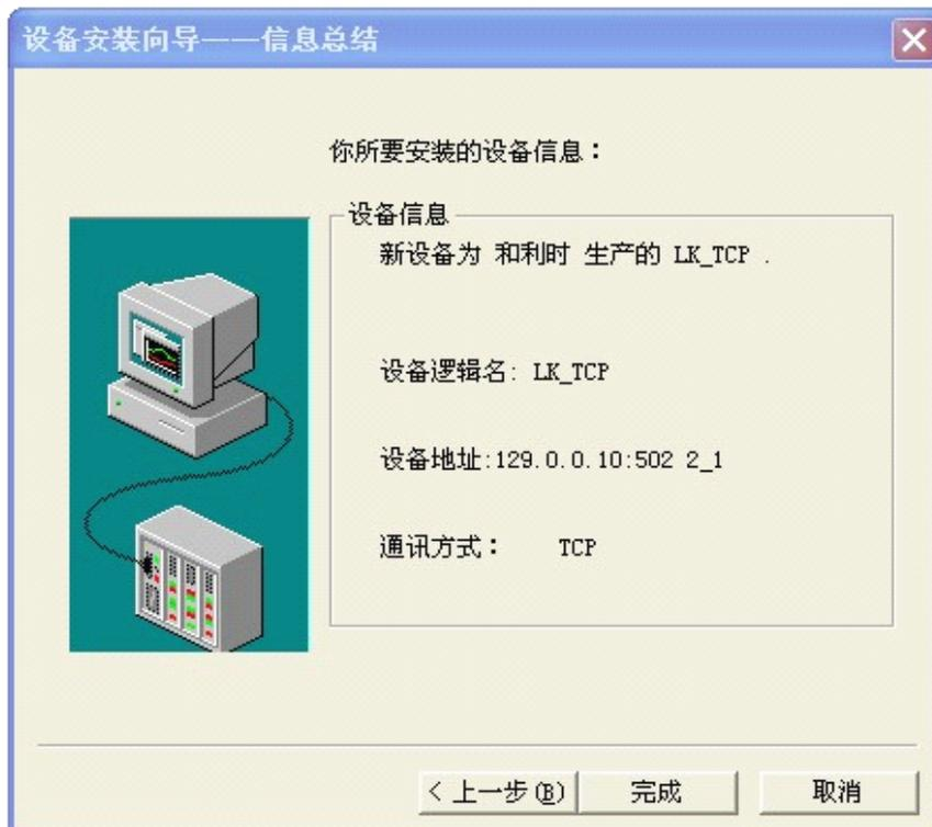
同样的方法建立设备冗余连接，需要注意的是设备冗余的连接地址参数项应设置为，IP地址应为主IP地址的基础上加128. 从设备标志为2. 如下图。
