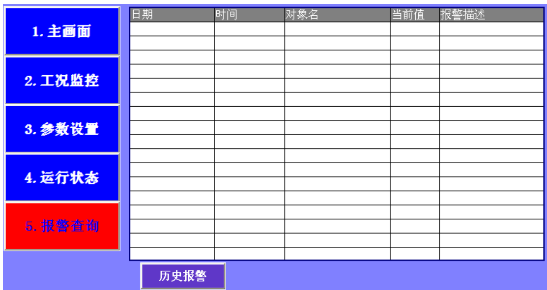
图 6 触摸屏报警查询画面
