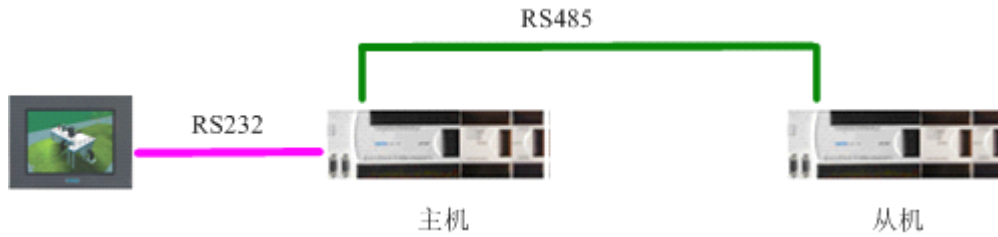
图 2-1 恒温恒湿空调控制系统结构图
